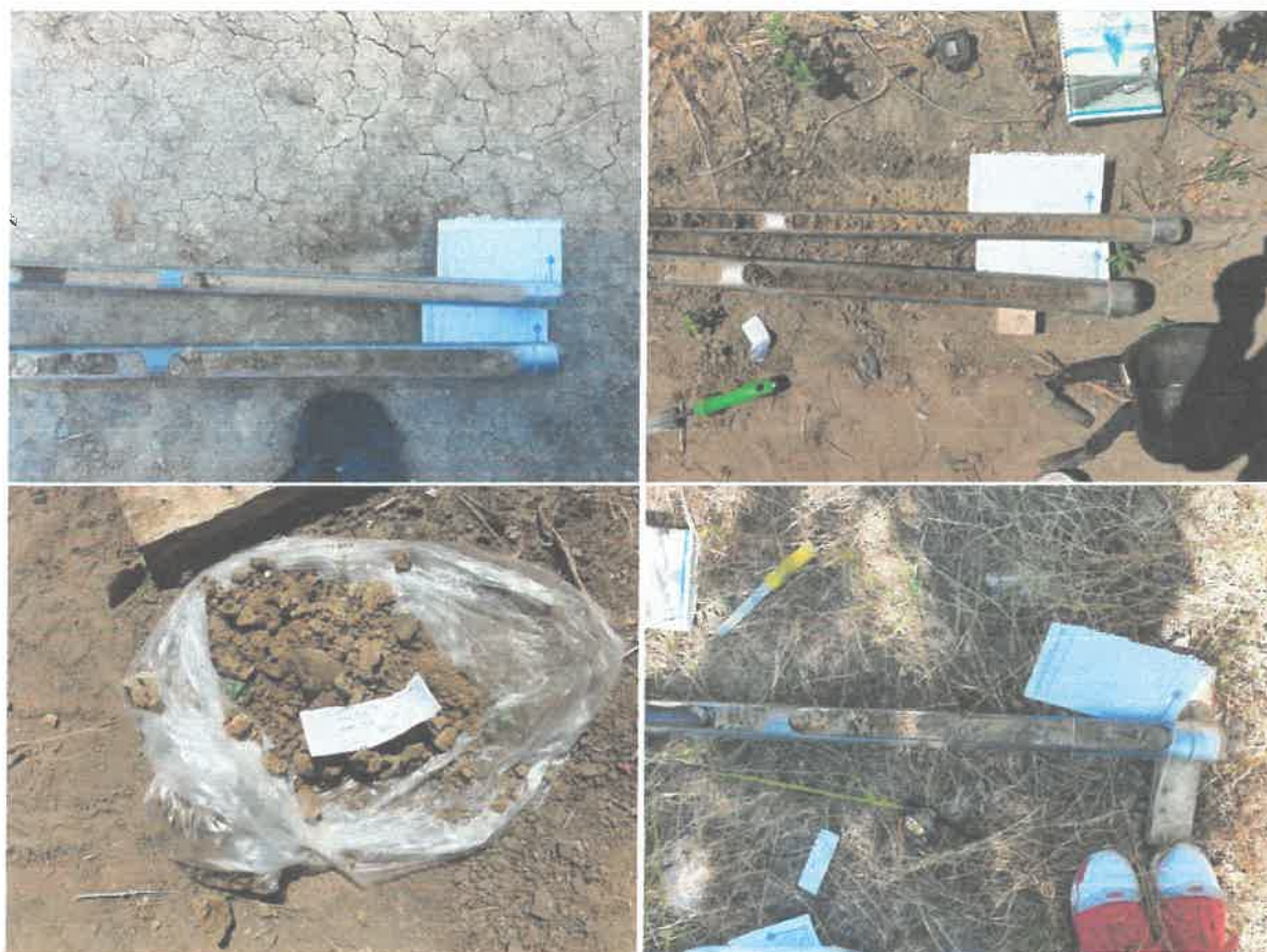
Fig. 11 Realizare foraje geotehnice și prelevare probe de pământ
